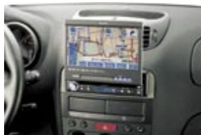
Das Eclipse AVN8826 von Fujitsu Ten vereint in einem Gerät Audio, Visual Entertainment und Navigation (AVN).
